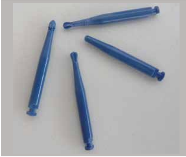
Fig. 15. Fresas PolyBur con distinto grado de uso (se aprecia una que se ha partido)
