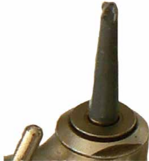
Fig. 4. Acusado desgaste de una fresa SmartPrep embotada
