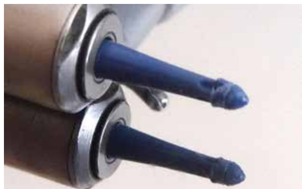
Fig. 14. Desgaste de la parte activa de una fresa PolyBur.
