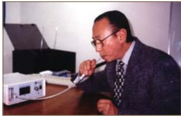
Fig. 2.B. Se sopla por el tubo y el aparato mide la halitosis.
