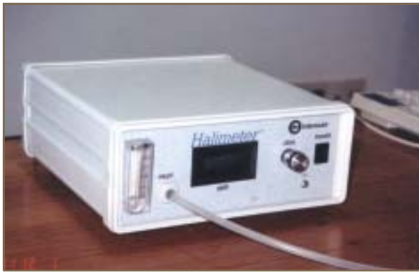
Fig. 2.A.- Halímetro. Aparato para medir halitosis.
