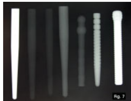
Fig. 7: Radiopacidad de los pernos radiculares prefabricados. De izquierda a derecha: Cerapost ® de óxido de zirconio; Dentin-Post ® de fibra de vidrio; Luscent Anchor ® de fibra de vidrio; DT Light Post ® de fibra de cuarzo; Parapost Fiber White ® de fibra de vidrio; Tenax ® de aleación de titanio; Parapost ® de acero inoxidable.
