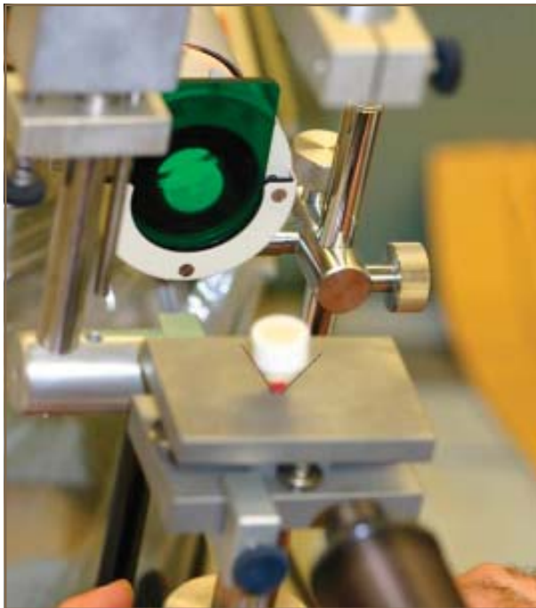
Figura 1. Goniómetro electrónico utilizado para medir el grado de convergencia de las preparaciones.
